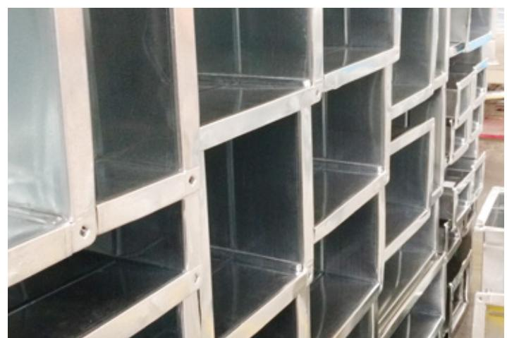
Com um processo quase que totalmente automatizado, os dutos e conexões podem ser fornecidos em partes ou totalmente montados em TDC com flange 25mm ou 35mm e cravado ou ainda soldados. Sendo confeccionados em Aço Galvanizado, Aço inoxidável, Aço carbono (Com ou sem acabamento) e Alumínio.
